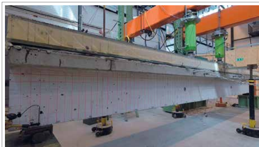
Fig. 9: Prova di laboratorio su una trave prototipo rinforzata
